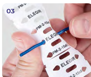
03 Согните ленту и проденьте проводник сквозь оба отверстия маркера
