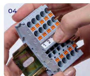
04 Вдавите маркировку до щелчка в паз (вариант маркировки сверху)
