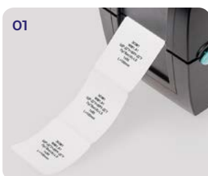
01 Распечатайте обозначения на кабельных бирках
