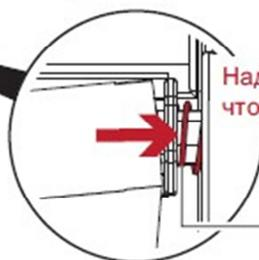
Надавите на пустую сердцевину для ленты, чтобы затянуть пружину держателя
