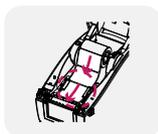
Протяните маркировочный материал через направляющие и отрегулируйте направляющие под ширину маркировочного материала.
