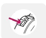
Поднимите держатель катушки маркировочного материала, надавите на защелку вправо и поднимите держатель.
