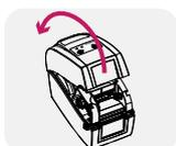
Плавно поднимите крышку принтера. Блок с механизмом печати поднимается вверх вместе с крышкой.
