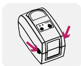
Потяните защелки на себя, чтобы открыть крышку принтера.
