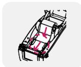
Протяните маркировочный материал через направляющие и отрегулируйте направляющие под ширину маркировочного материала.
