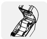
Убедитесь, что материал установлен в направляющих и немного выходит из корпуса принтера. Плавно опустите крышку и механизм печати в рабочее положение, закройте крышку до щелчка.
