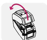
Плавно поднимите крышку принтера. Блок с механизмом печати поднимается вверх вместе с крышкой.
