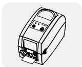
Маркировочный материал должен выходить из принтера на 1-2 наклейки. Пример правильной установки материала. Принтер готов к работе.
