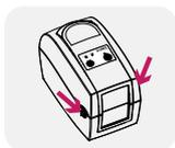
Потяните защелки на себя, чтобы открыть крышку принтера.
