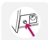
Откалибруйте принтер, нажав на кнопку калибровки, которая находится на задней панели принтера, в течении 3-5 секунд, пока не загорятся индикаторы POWER и STATUS зеленым и красным цветом попеременно.
