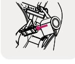
Установите катушку с кабельными бирками на держатель катушки и опустите до щелчка.
