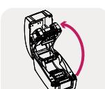
Поднимите крышку принтера, механизм печати поднимется вместе с крышкой.
