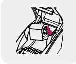
**ВАЖНО!** При установке маркировки избегайте касания с областью печати - возможные загрязнения на материале могут негативно сказаться на качестве печати.
